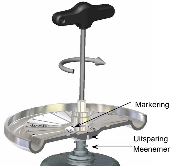
Afbeelding 1 Afstemming rotor en motor
