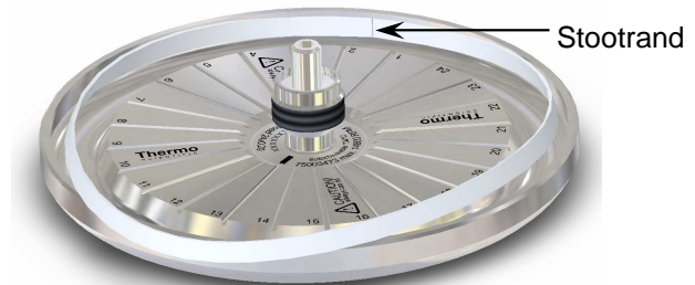
Afbeelding 3 Inleggen van de witte rubberstrip
