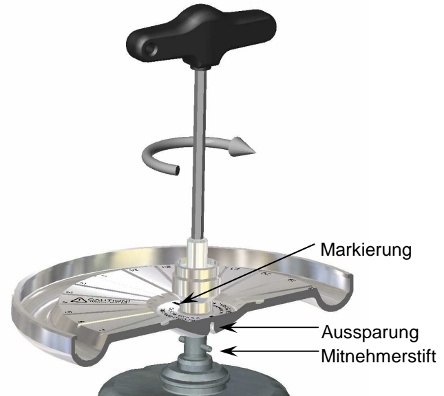
Abbildung 1 Ausrichtung Rotor und Motor
